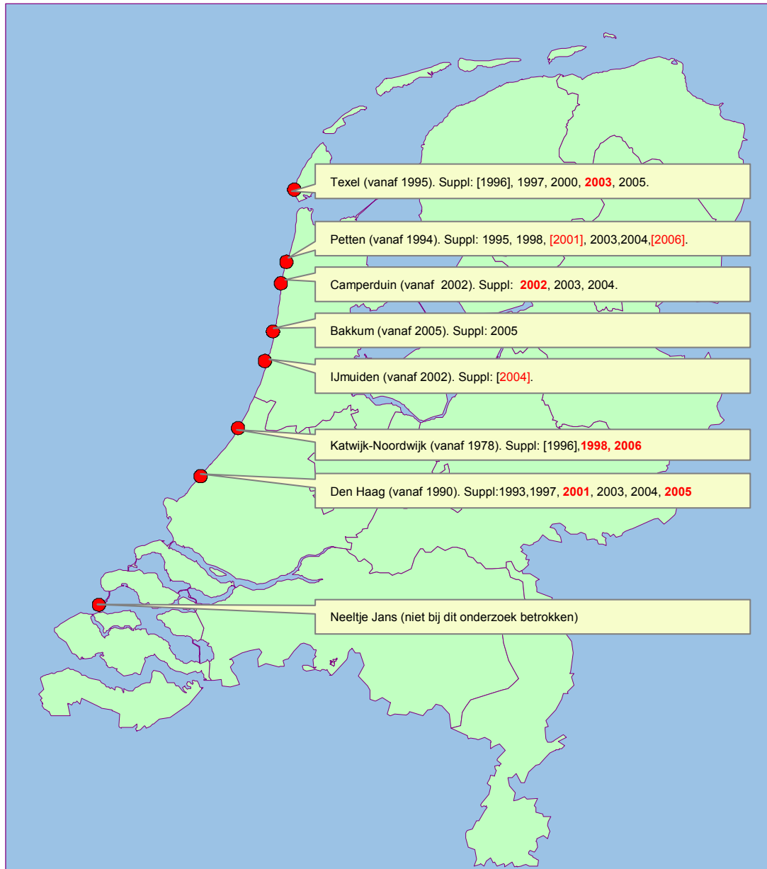
Figuur 1.1. Overzicht van de ligging van Strandwachtrajecten, het moment waarop deze zijn gestart en de jaren waarin strand- of onderwatersuppleties zijn uitgevoerd op een afstand kleiner dan 3 km of alleen zijn uitgevoerd op een afstand tussen de 3 en 8 km tot het traject. Bij deze afstand gaat het om de afstand evenwijdig aan de kustlijn en niet zeeinwaards. Zwarte jaartallen betreffen strandsuppleties. Rode jaartallen betreffen onderwatersuppleties. Jaartallen tussen blokhaken betreffen strand- of onderwatersuppleties die zijn uitgevoerd op een afstand tussen de 3 en 8 km tot het traject evenwijdig aan de kust
